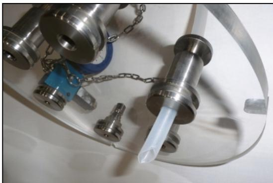
Рис. 3: Открытая крышка с зажатой трубкой
