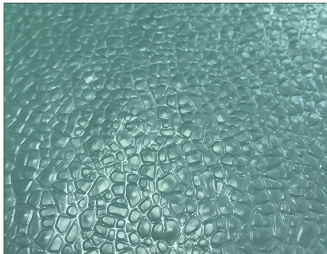
Pic.1 Embossing with «cracked ice» pattern
