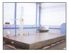
программного обеспечения POWER INSPECT DELCAM и специализированного стенда контроля качества оснастки. Стенд для измерения и цифрового кодирования имеет рабочую зону 6000 мм x 3000 мм x 2000 мм.
