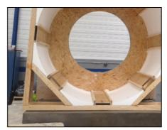
Моделирование поверхности Мастер-модели: включает нанесение на подготовленную структуру эпоксидного компаунда SK2TM70. Для достижения наилучших прочностных характеристик Мастермодели проводится термостабилизация компаунда.
