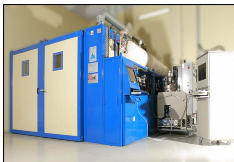
Тепловой модуль: 3×4×2м, объем 24м³, Рабочая T=220°C
