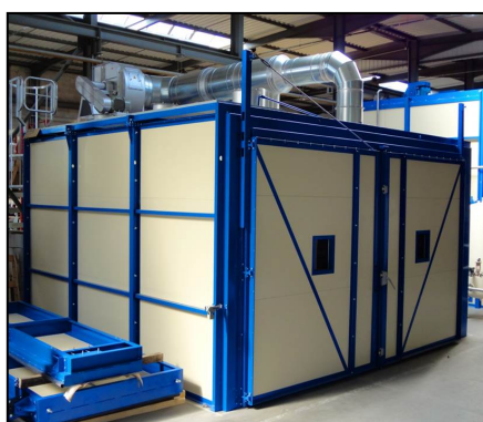
Тепловой модуль: 5,5×6×3м, объем 99м³, Рабочая T=220°C
