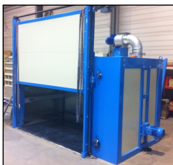
Тепловой модуль: 2,1×1,1×1,3м, объем 3м³, Рабочая T=250°C
