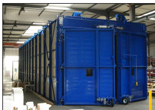
Тепловой модуль: 6×22×4м, объем 528м³, Рабочая T=220°C
