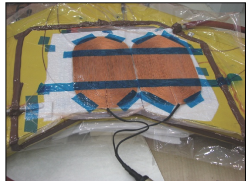
Рисунок 3: Ремонт алюминиевой балки пола ATR-72 с использованием приклеенной углеродной заплаты, выполненный на месте компанией GMI Aero, в сотрудничестве с компанией ATR.
