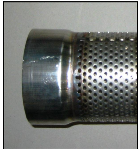
ESD Rohr aufweiten Material: 1.4828 Dicke: 1,0 mm
