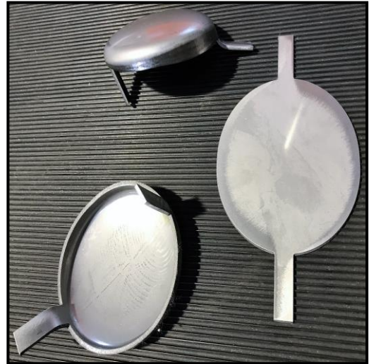
Deckel pressen Material: 1.4301 Dicke: 2 mm
