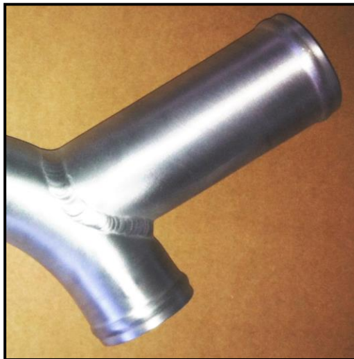
Kühlwasserrohr sicken Material: AlMgSi0,5 Dicke: 1,5 mm
