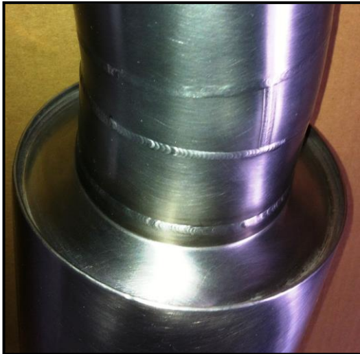
Material: Inconel 625 Schweißart: WIG Dicke: 0,8 mm
