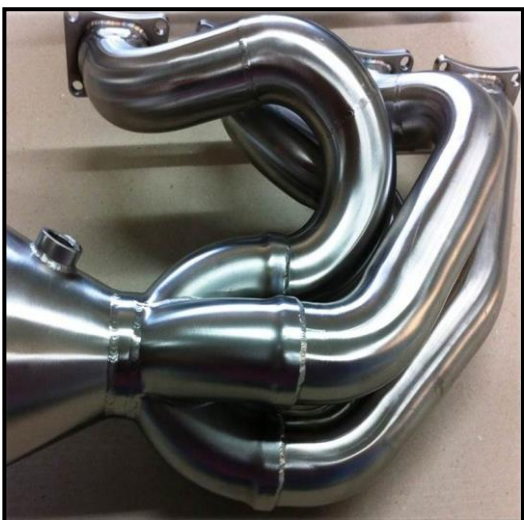
Material: 1,4828 Schweißart: WIG Dicke: 0,8-1,5mm
