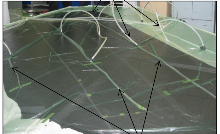
Спиральная трубка для распределения связующего (внутри вакуумного мешка)
