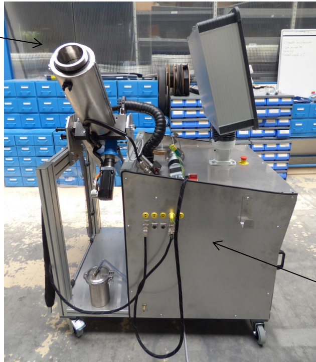
Рисунок 2: вид сзади RTM установки с ПЛК
