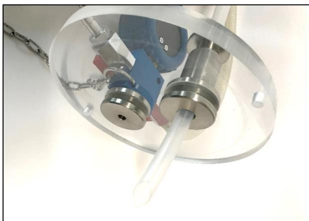
Подсоединение ловушки к вакуумному мешку осуществляется при помощи прижимного фитинга, расположенного на прозрачной крышке на ловушки. Данный фитинг специально разработан компанией VIK-COMPOSITE для предотвращения загрязнения при контакте со связующим.
