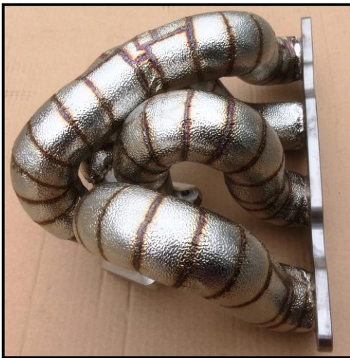
Krümmen Folie: 0,15mm Isolierung 6mm
