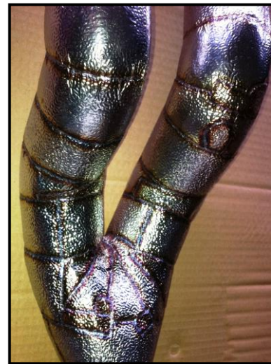
Turbinen ESD, Modellbau _Folie: 0,1 mm Isolierung: 10 mm
