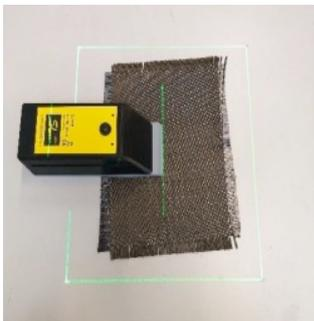
Оператор размещает инструмент контроля направления волокна вдоль линии лазерной проекции. Система сравнивает реальное направление с направлением в библиотеке. При нахождении в допустимом интервале отклонений, установленном заказчиком, система SL3D подтверждает последовательность выкладки.
