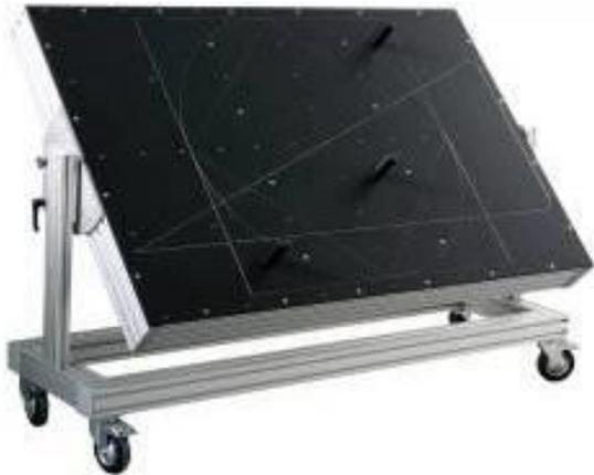
Во-вторых, этот инструмент используется для оценки проекторов, чтобы комплектующие могли изготавливаться с использованием квалифицированных лазерных систем, особенно для комплектующих BOEING.
