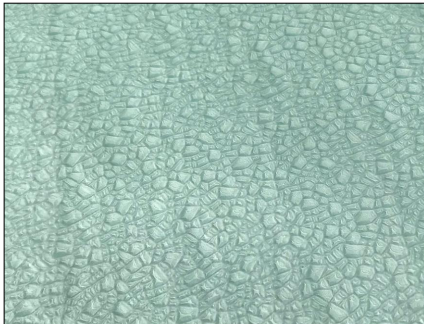
Pic.1 Embossing with «cracked ice» pattern
