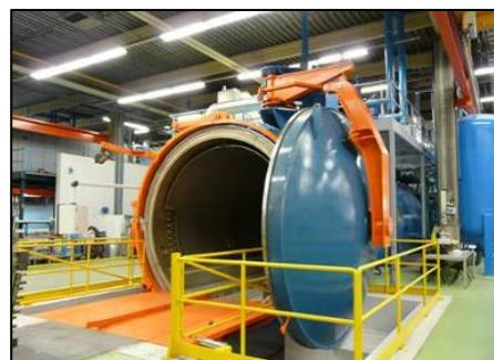
Герметичность гарантирована использованием специального профильного герметика, который позволяет обеспечить идеальную герметичность автоклава даже в случае небольших деформаций фланцевых соединений, возникающих в результате сварки.
